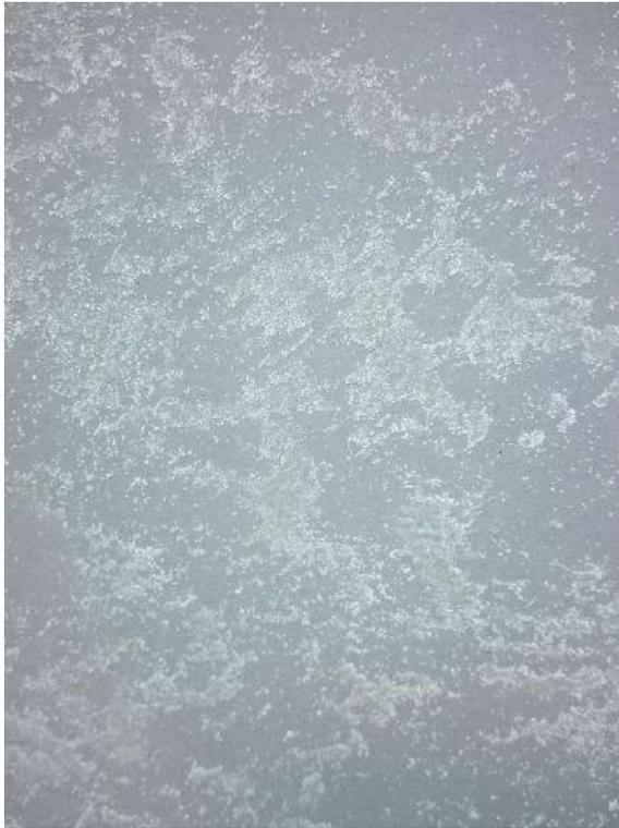
Декоративное покрытие со светорассеивающими микросферами. Эффект отражающего светового перелива достигается за счет рассеивания света сферической поверхностью микросфер.
